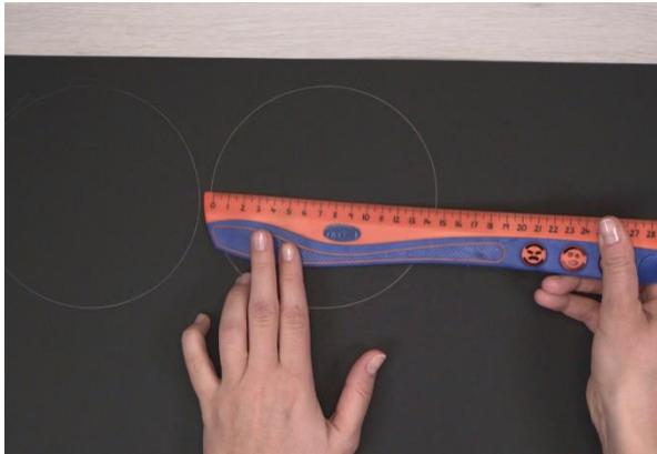
Den Durchmesser des Kreises abmessen. In diesem Fall sind es 14,5 cm. Damit wird der Umfang des Kreises berechnet. Dazu multipliziert man den Durchmesser mit  $\pi$ . Der Kreisumfang beträgt hier 45,6 cm.
